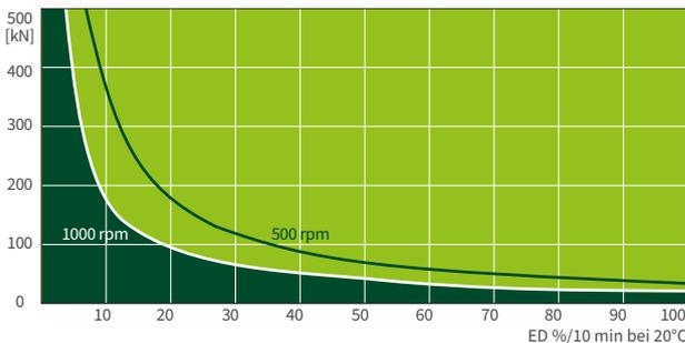
Diese Kennfelder dienen zur Orientierung unter industriellen Standardbedingungen (Umgebungstemperatur 20°C etc.) und richtiger Wartung (Schmierung etc.). Die Kennfelder basieren auf ZIMM Standard Trapezgewinde Tr 120x16. Bei Kugelgewinde KGT können die Einschaltzeiten ein vielfaches mehr betragen.
