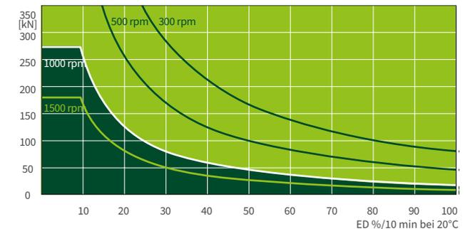
Diese Kennfelder dienen zur Orientierung unter industriellen Standardbedingungen (Umgebungstemperatur 20°C etc.) und richtiger Wartung (Schmierung etc.). Die Kennfelder basieren auf ZIMM Standard Trapezgewinde Tr 100x16. Bei Kugelgewinde KGT können die Einschaltzeiten ein vielfaches mehr betragen.
