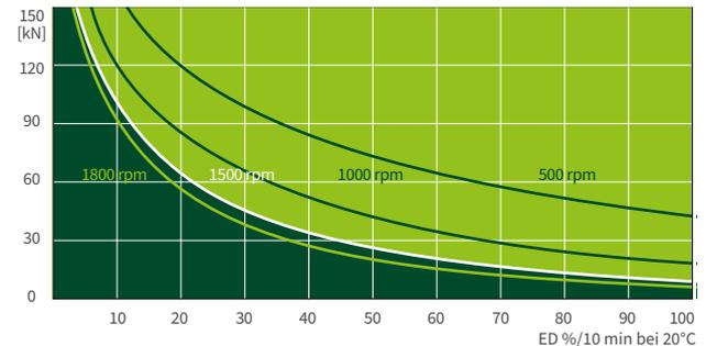
Diese Kennfelder dienen zur Orientierung unter industriellen Standardbedingungen (Umgebungstemperatur 20°C etc.) und richtiger Wartung (Schmierung etc.). Die Kennfelder basieren auf ZIMM Standard Trapezgewinde Tr 60x9. Bei Kugelgewinde KGT können die Einschaltzeiten ein vielfaches mehr betragen.
