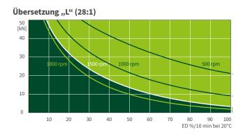
Diese Kennfelder dienen zur Orientierung unter industriellen Standardbedingungen (Umgebungstemperatur 20°C etc.) und richtiger Wartung (Schmierung etc.). Die Kennfelder basieren auf ZIMM Standard Trapezgewinde Tr 50x8. Bei Kugelgewinde KGT können die Einschaltdauern ein vielfaches mehr betragen. Benötigen Sie eine noch höhere Einschaltdauer bzw. Leistung, finden Sie Hinweise zu unseren Hochleistungsgetrieben ZE-H auf S. 70 und 71.
