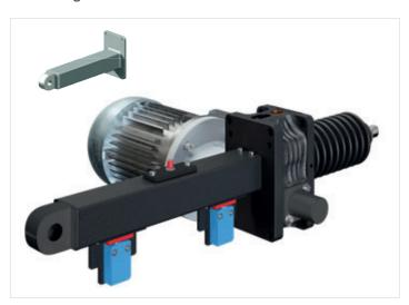
Das **Schwenklagerstützrohr STRO** hat den Vorteil, dass die Schwenkpunkte ganz außen sind. Nachteil ist, dass das Getriebe- und Motorgewicht in der Mitte ist. Die Fertigung ist immer kundenspezifisch.
