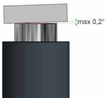
Belasting is los geplaatst
