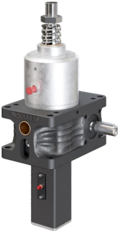
La propreté du fonctionnement est très importante pour de nombreuses raisons. Tous les composants lubrifiés sont intégrés dans le corps du vérin, ou recouverts d'un tube de protection standard. Les soufflets de protection (en option) protègent à la fois les artistes et les accessoires de la graisse et la vis elle-même qui pourrait être exposée aux salissures, aux débris et à l'humidité.
