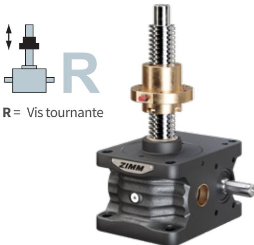
Notons qu'il existe aussi deux versions de vis, trapézoïdales et à vis à billes, présentant chacune des avantages et des inconvénients. La vis trapézoïdale est plus commune, avec son design simple, économique et solide. Elle présente cependant aussi un avantage unique : la friction générée par la charge engendre une irréversibilité du système, très important en particulier en cas de perte de puissance d'alimentation du moteur d'entraînement du vérin.
