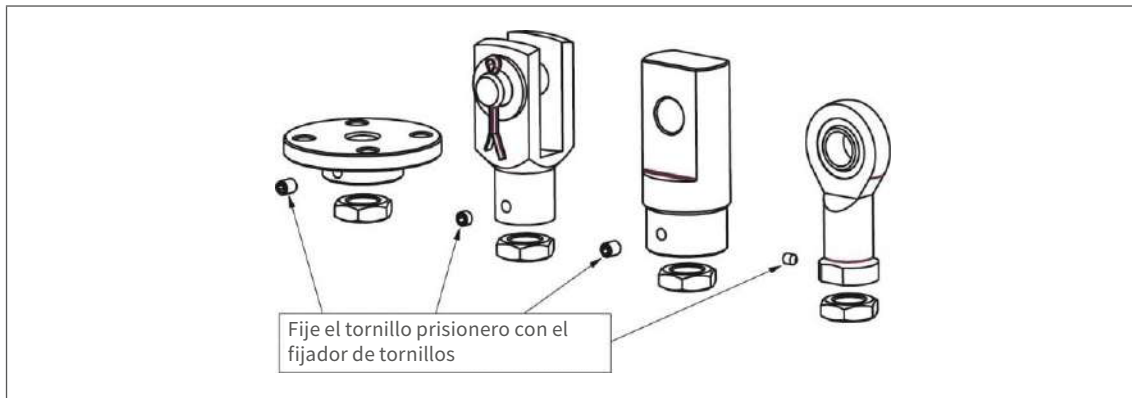
Fig. 7: Fijar las bridas, la horquilla, el cojinete giratorio y las cabezas de rótula después de ajustar la posición.
